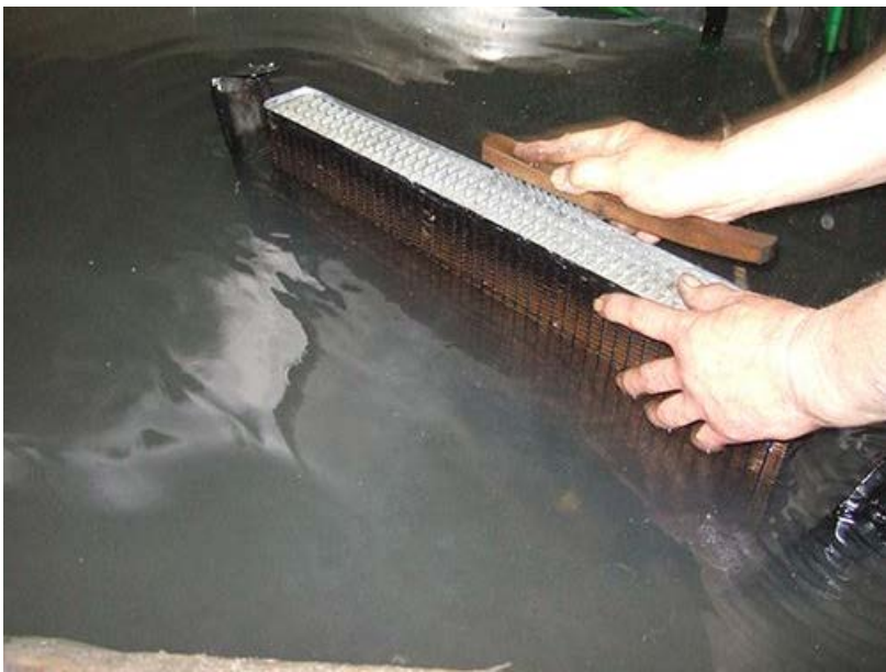
丁寧にハンダもりもりと修理中。
